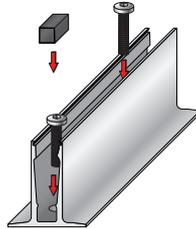
Verschrauben Sie das Profil mit der Unterkonstruktion und legen Sie die Klötze zwischen die Befestigungsmittel.
