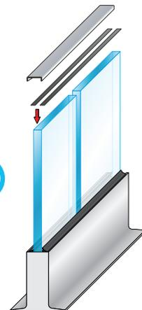
Kleben Sie das Glaskantenschutzprofil mit dem Klebeband auf die Glaskante.
