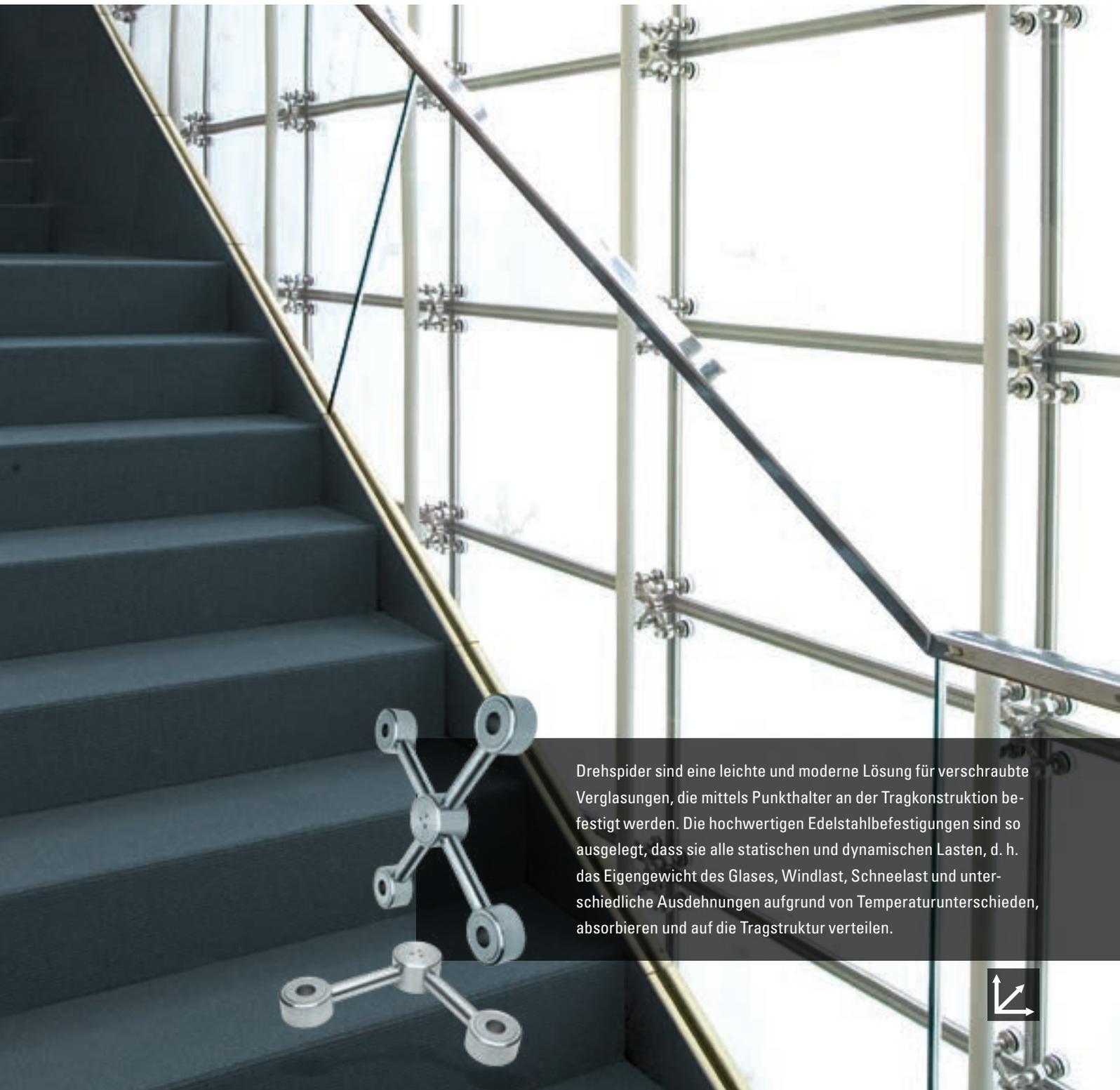
Drehspider sind eine leichte und moderne Lösung für verschraubte Verglasungen, die mittels Punkthalter an der Tragkonstruktion befestigt werden. Die hochwertigen Edelstahlbefestigungen sind so ausgelegt, dass sie alle statischen und dynamischen Lasten, d. h. das Eigengewicht des Glases, Windlast, Schneelast und unterschiedliche Ausdehnungen aufgrund von Temperaturunterschieden, absorbieren und auf die Tragstruktur verteilen.
