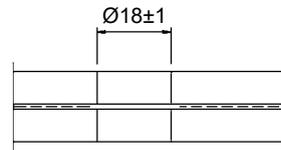
ESG – Zylindrische Bohrung
