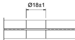
ESG – Zylindrische Bohrung
