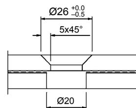
ESG – Senkbohrung
