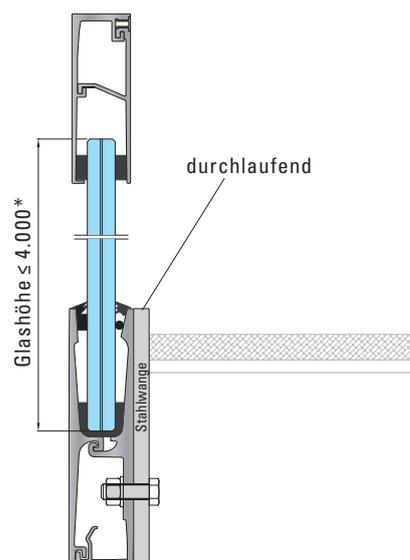
Auflagerhöhe min 100 mm.
