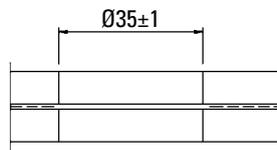
ESG – Zylindrische Bohrung
