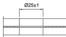
ESG – Zylindrische Bohrung
