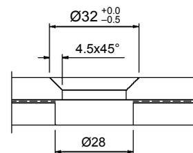
ESG – Senkbohrung
