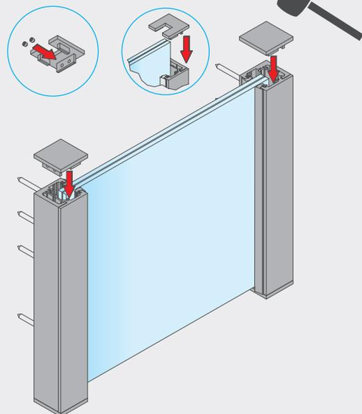
8. Stiftschrauben M5 so weit eindrehen, dass beim Einstecken des Deckels in das BALMERO-Profil eine Klemmwirkung erreicht wird. Deckel in das BALMERO-Profil, ggf. mit Kunststoffhammer einschlagen. Fertig!
