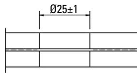
ESG – Zylindrische Bohrung
