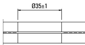
ESG – Zylindrische Bohrung
