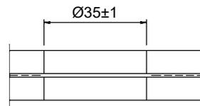
ESG – Zylindrische Bohrung
