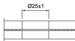
ESG – Zylindrische Bohrung
