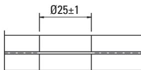
ESG – Zylindrische Bohrung
