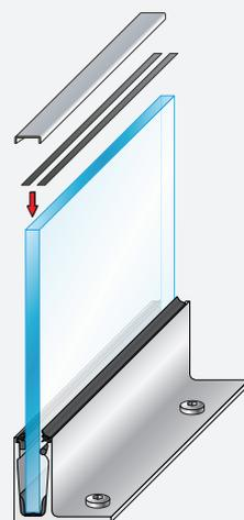
Montieren Sie das Glaskantenschutzprofil oder montieren Sie den Handlauf. Fertig!
