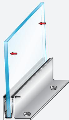
Drücken Sie das Glas gegen die Außendichtung und legen Sie die Klemmstäbe durchgehend (max. Abstand 50 mm) ein.
