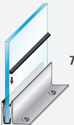
Setzen Sie die Innendichtung ein.
