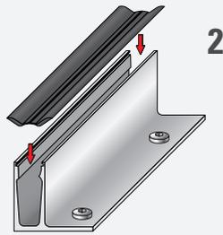
Setzen Sie den Klemmschuh ein (aufgedruckte Artikelnummer nach oben).
