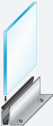
Setzen Sie die Glasscheibe ein. Luft zwischen Klemmschuh und Glasscheibe 3-5 mm.
