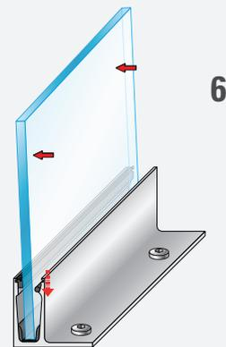
Drücken Sie die Glasscheibe nach außen, bis die Klemmstäbe in die Profiltrillen einrasten. Gegebenenfalls sind die Klemmstäbe mittels Setzwerkzeug einzuschlagen.
