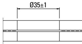
ESG – Zylindrische Bohrung
