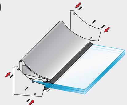
Fixieren Sie die Seitenabdeckungen und die Blende mit den Sicherungsschrauben. Optional können zusätzlich Abschlussbleche aufgeklebt werden.
