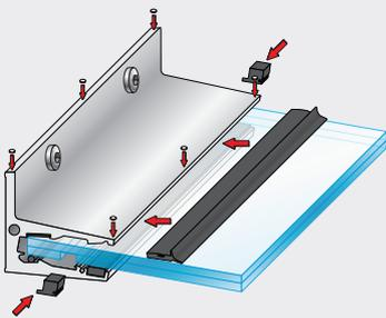
Fixieren Sie die Glasscheibe beidseitig mit den Sicherungsklötzen. Drücken Sie die vordere Auflagerdichtung zwischen Glas und Profil. Kleben Sie die Silikonpuffer in regelmäßigen Abständen auf Profi-ober- und -vorderkante.
