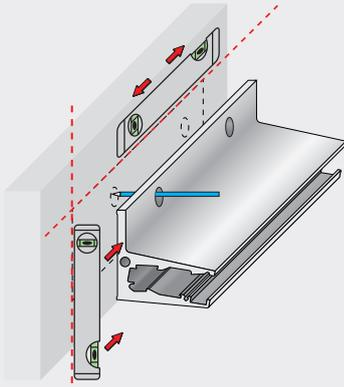
Richten Sie die Unterkonstruktion aus. Bestimmen Sie die Befestigungspunkte mit Hilfe des Profils.
