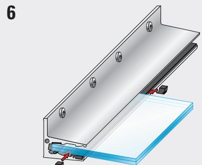
6 Führen Sie die erste Glasscheibe bis zum Profilschlag ein.
