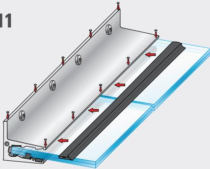
Nach Ausrichtung der Glasscheiben drücken Sie die vordere Auflagerdichtung zwischen Glas und Profil. Für Blenden, die an beide Seitenabdeckungen anschließen, kleben Sie die Silikonpuffer in regelmäßigen Abständen auf Profilver- und vorderkante auf und legen Sie die Blende auf das Profil.
