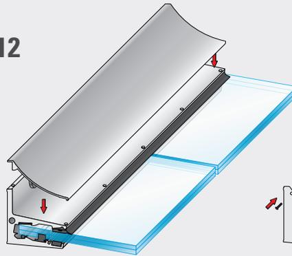
Blenden, die nicht an beide Seitenabdeckungen anschließen, sind mit geeigneten Mitteln auf dem Profil zu fixieren (z.B. mit doppelseitigem Klebeband oder Silikon).
