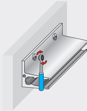
Befestigen Sie das Profil an der Unterkonstruktion bzw. dem Baukörper mit geregelten/zugelassenen Verbindungsmitteln.
