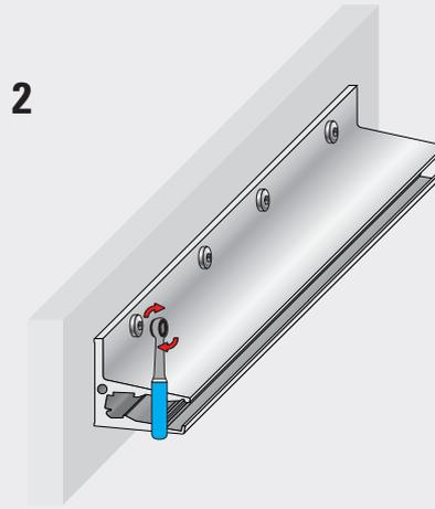
2 Befestigen Sie das Profil an der Unterkonstruktion bzw. dem Baukörper mit geregelten/zugelassenen Verbindungsmitteln.
