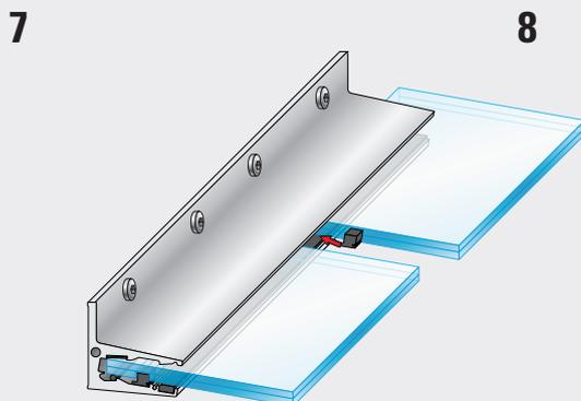
7 Führen Sie nun die nächste Glasscheibe bis zum Profilschlag ein. Achten Sie dabei darauf, dass zwischen den Scheiben ausreichend Abstand (ca. 150 mm) bleibt, um den Sicherungsklotz der zweiten Scheibe korrekt in die Profinnut einzulegen.
