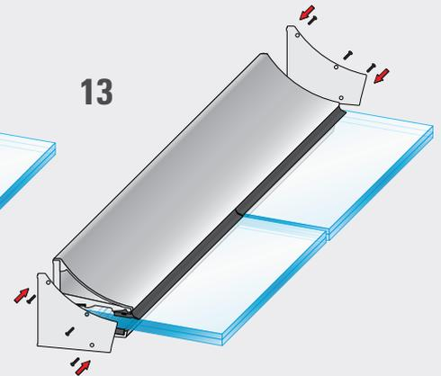
Fixieren Sie die Seitenabdeckungen und die Blende mit den Sicherungsschrauben. Optional können zusätzlich Abschlussbleche aufgeklebt werden.
