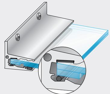
Führen Sie die Glasscheibe bis zum Profilanschlag ein.
