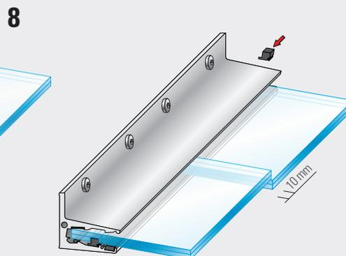
8 Befestigen Sie im Bereich der Profilverkante einen Glasabstandhalter 10 mm an einer Glasscheibe. Heben Sie die zu verschiebende Scheibe an der Vorderkante etwas an, um sie so im Profil zu verschieben, dass der Abstand zwischen zwei Glasscheiben ca. 10 mm beträgt. Fixieren Sie die Glasscheibe mit dem zweiten Sicherungsklotz. Überprüfen Sie nochmals den Sitz der beiden Sicherungsklötze.
