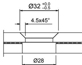
ESG – Senkbohrung
