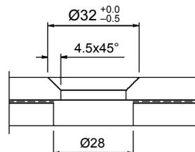
ESG – Senkbohrung
