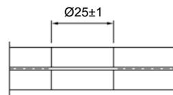
ESG – Zylindrische Bohrung
