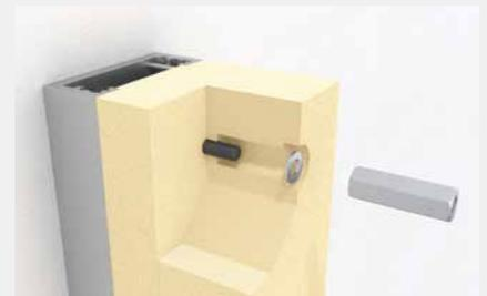
Führen Sie die Unterlegscheiben und Gewindemuffen bis zu den Gewindestangen und befestigen Sie diese mit einem Anziehmoment von 10 Nm.
