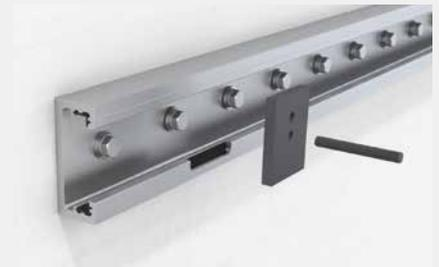
Schrauben Sie die zugfesten Gewindestangen in die Einschubplatten und führen Sie die Einschubplatten in die Alu-Tragschiene.
