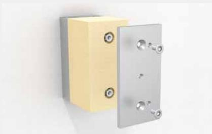
Montieren Sie eine Adapterplatte mit geregelten/zugelassenen Verbindungsmitteln mit einem Anziehmoment von 24 Nm bei M10 bzw. 12 Nm bei M8.
