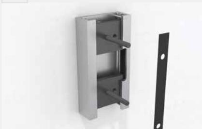
Richten Sie die Einschubplatten durch Verschieben an der vorgebohrten Montagehilfe aus und fixieren Sie diese.
