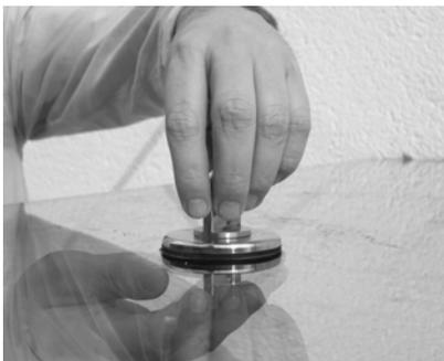
CL04 und CL05 werden an CL00 befestigt und mit Hilfe eines Drehmomentschlüssels definiert festgezogen (Drehmoment: 8 Nm). Dabei ist auf eine korrekte Ausrichtung für die Befestigung an CL02 und CL03 zu achten.
