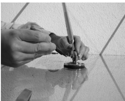
Komponente CL03 wird durch Anbringen der Sicherungsringe an die Bolzen gesichert.
