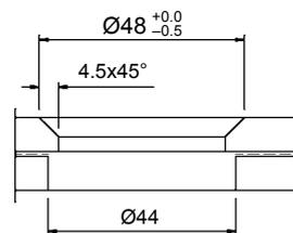
ESG – Senkbohrung
